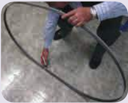
1.Colocar la soldadura contra el suelo y hacer una marca con un rotulador.
