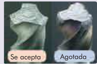
DESPRENDIMIENTO DE LA CABEZA
