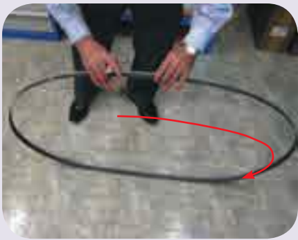
2. Hacer girar la cinta hasta volver a encontrar la soldadura en el suelo.
